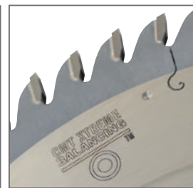
Fig. 2 Esempio di lama controllata ma già perfettamente bilanciata.
